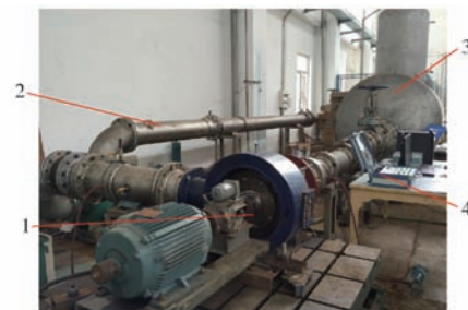
图4 试验装置图 Fig.4 Photo of experiment setup 1. 混流泵 2. 试验管路 3. 稳压罐 4. HSJ2010 型水力机械综合测试仪
