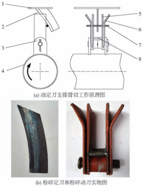
图 1 秸秆粉碎装置工作原理及关键部件实物图 Fig. 1 Work principles of straw-chopping device and photo of its principal parts 1. 定刀板 2. 等滑切角式粉碎定刀 3. 刀座 4. 刀辊 5. 直刀 6. L 改进型弯刀 7. 秸秆 8. 焊接平板
