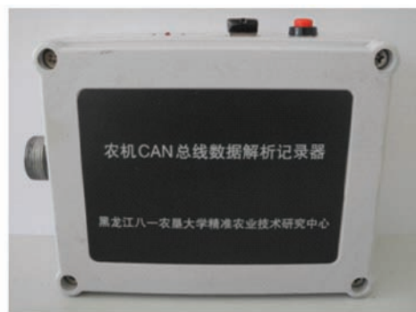
图 2 拖拉机 CAN 总线数据解析记录器
