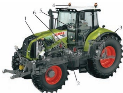
图 1 拖拉机 CAN 总线网络解析示意图
