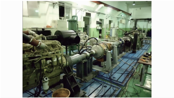
图 10 变速器台架试验装置
