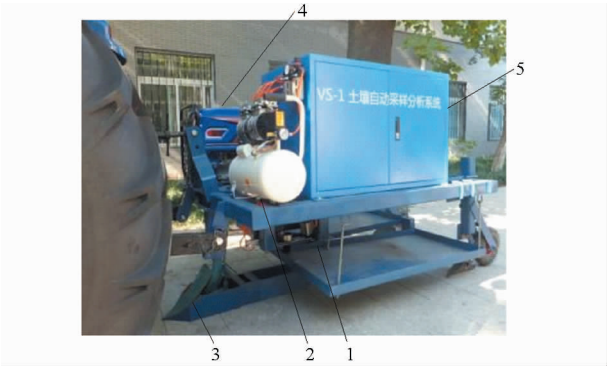
图2 土壤养分在线检测装置的外观图 Fig.2 Picture of soil nutrient on-line detecting system 1. 检测部件 2. 气泵组件 3. 开沟犁 4. 发电机 5. 光谱检测及控制单元
