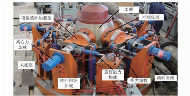
图 3 CPP 加载试验台架
