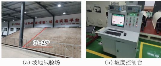
图 5 丘陵山地“土壤-机器-作物”综合实验平台
