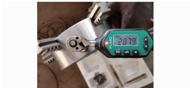
图 13 驱动伞齿轮扭矩测量
