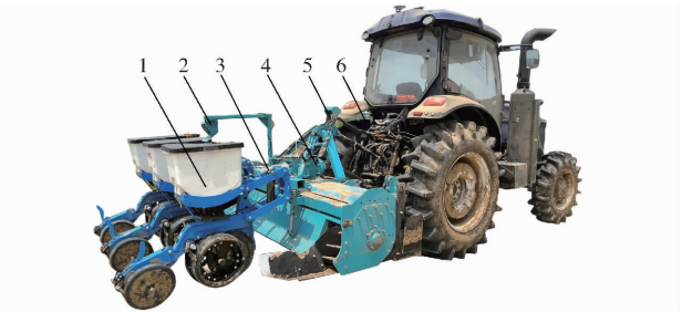
图 1 棉花精量直播机整体结构示意图 Fig. 1 Overall schematic of cotton precision planter 1. 播种单体 2. 测速雷达 3. 风机 4. 旋耕机 5. 行程开关 6. 拖拉机
