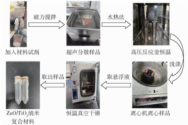
图 3 ZnO/TiO 2 纳米复合材料制备 Fig. 3 Preparation of ZnO/TiO 2 nanocomposites
