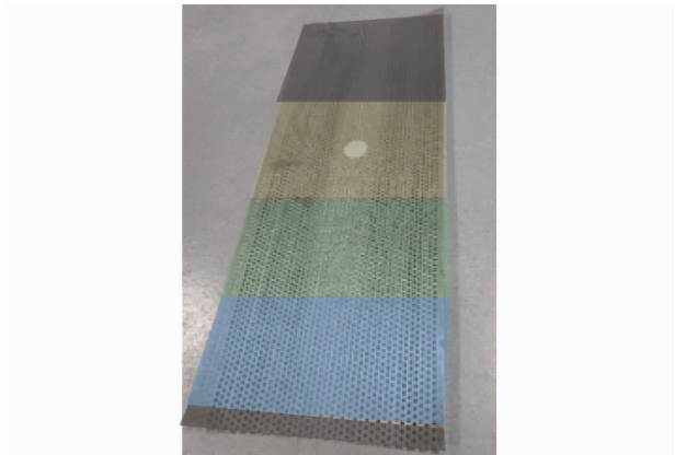
图 10 破损筛网示意图 Fig. 10 Schematic of broken screen
