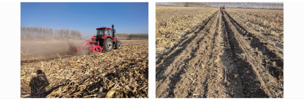
图 12 间隔深松机作业过程及效果
