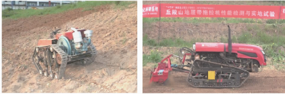
(a) 基于“液压差高装置”的小型山地履带拖拉机 (b) 基于“平行四杆机构”的全向调平地履带拖拉机
