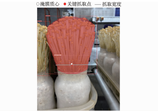
图 17 瓶栽金针菇抓取宽度分析
