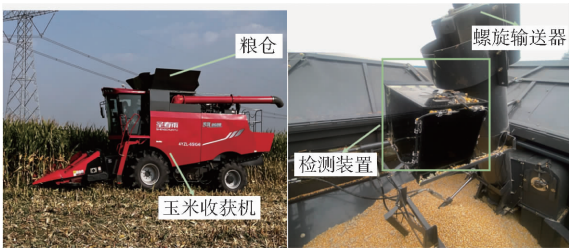
(a) 检测装置安装位置
