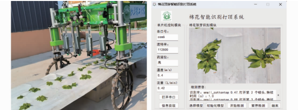
图 11 对靶喷施试验以及试验界面
