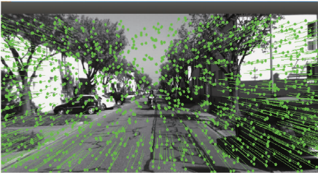
图 12 直接法光流追踪 Fig. 12 Direct optical flow tracking
