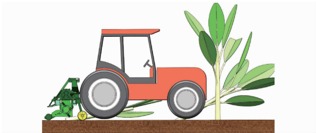
图 2 香蕉秸秆粉碎还田机作业示意图
