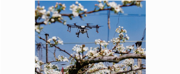
图 2 大疆 MG-1S 型无人机液体授粉作业现场 Fig.2 Field of MG-1S UAV liquid pollination in DJI
