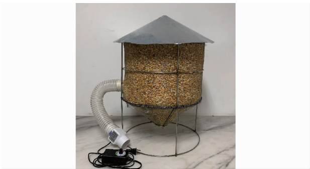
图 4 小型试验台 Fig.4 Test platform of small silo
