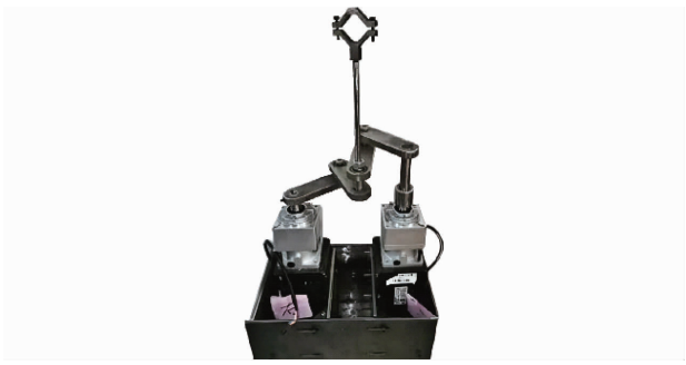
图 4 连杆旋轮线采收机构
