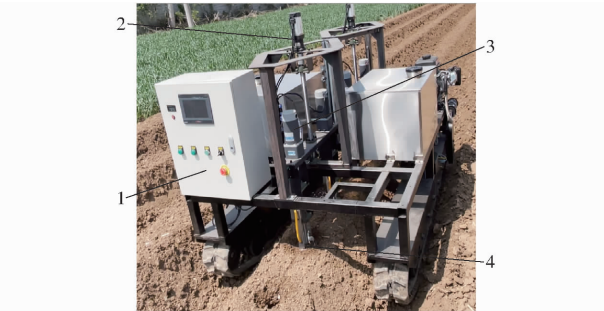
图 13 试验台架 Fig. 13 Test bench 1. 控制柜 2. 钻进电机 3. 旋转电机 4. 单线螺旋成穴装置
