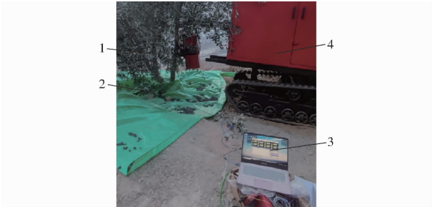
图 13 振幅测量系统 Fig. 13 Amplitude measuring system 1. 位移传感器 2. 三脚架 3. 计算机 4. 油橄榄采收机
