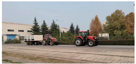
图 11 最大负荷加载试验 Fig. 11 Maximum load loading test
