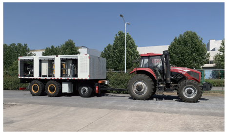
图 10 负荷车牵引试验 Fig. 10 Load vehicle traction power test
