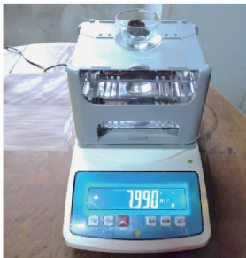
(c) 土壤容重和土壤孔隙度测试
