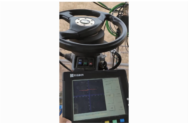
图 19 无人驾驶系统安装 Fig. 19 System installation
