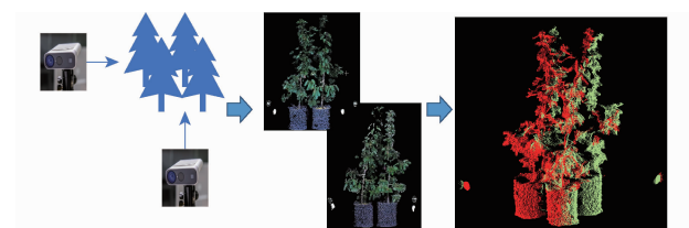
图 14 基于标靶球的点云配准结果
