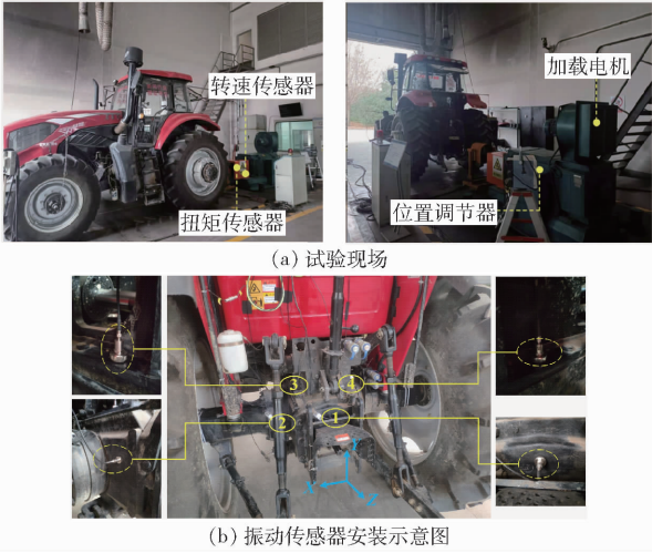
图 6 拖拉机 PTO 加载台架试验 Fig. 6 Tractor PTO loading bench experiment
