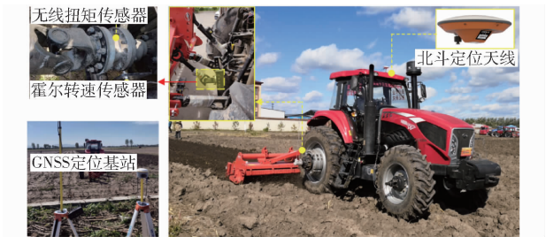
图 9 田间旋耕作业数据采集试验
