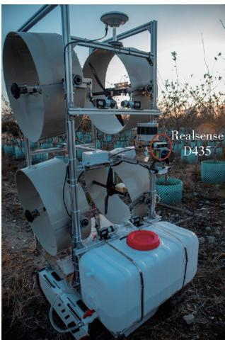
图 4 喷雾机器人试验平台
