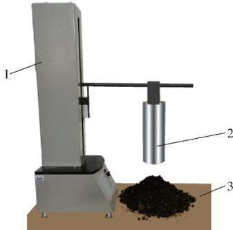
图2 圆筒提升法堆积角测试装置
