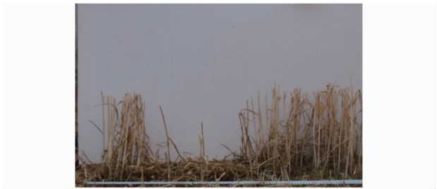
图 3 立茬投影面积的测试方法 Fig. 3 Test method of standing stubble projected area
