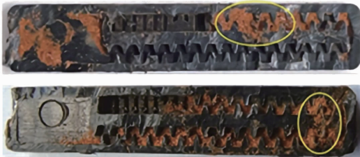
图 6 动态水压滴头的堵塞情况
