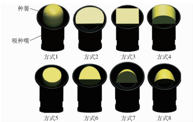
图 6 不同形态种薯的吸附方式
