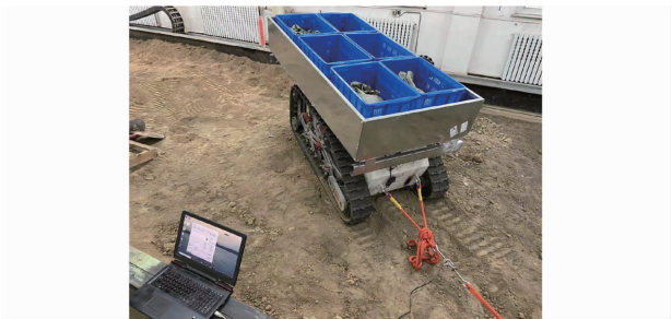
图 14 运输车通过性试验
