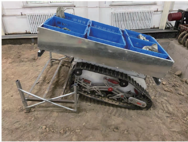
图 16 斜坡越障试验
