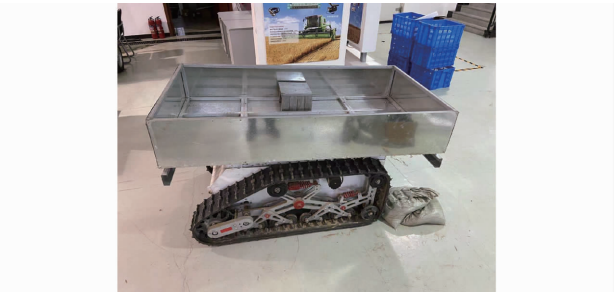
图 13 重心估计试验 Fig.13 Test of gravity core estimation
