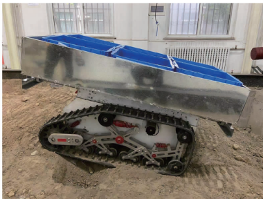
图 17 斜坡跨壕试验
