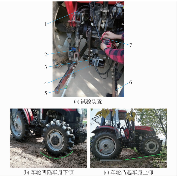
图 12 耕深自动监控系统准确性试验
