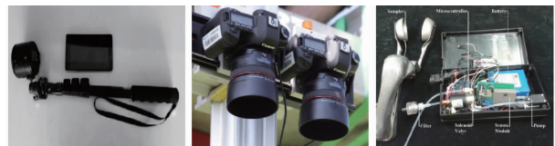
(a) 可伸缩手持杆式设备 (b) 立体相机装置 (c) 炭黑聚合物复合传感器
