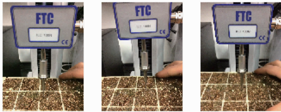
(b) 在顶苗器 U 型末端侧边 I / II 作用区域内选取穿刺试验位置
