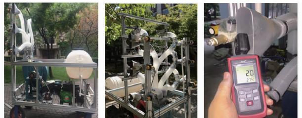
(a) 节流调风装置 (b) 旁路调风装置 (c) 风速测量
