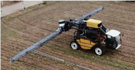
图7 自走式喷杆喷雾机田间试验
