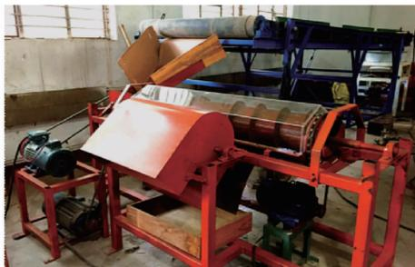
图 13 分离清选装置试验现场
