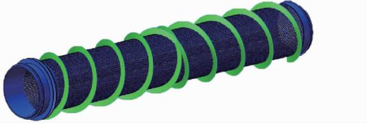
图 8 圆筒筛三维模型
