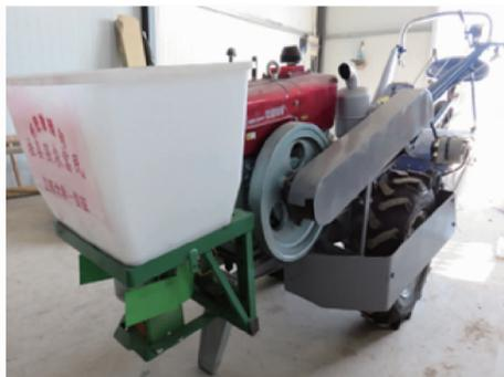
图3 撒肥机整机结构图
