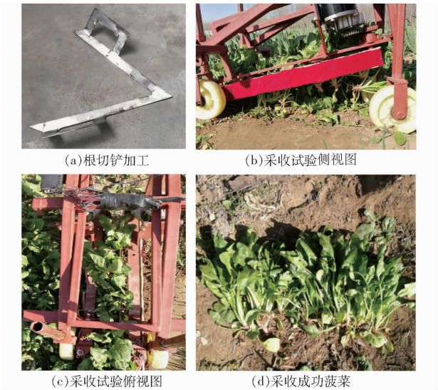
图 20 根切铲加工与试验
