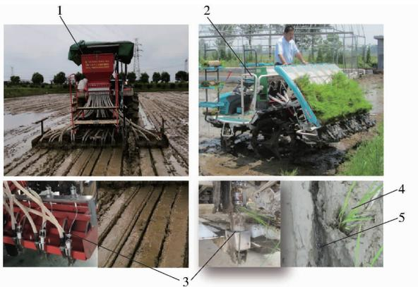
图11 带强制排肥部件的水稻施肥机田间试验
