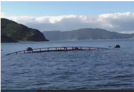
图 3 HDPE 网箱升降倾覆现场图
