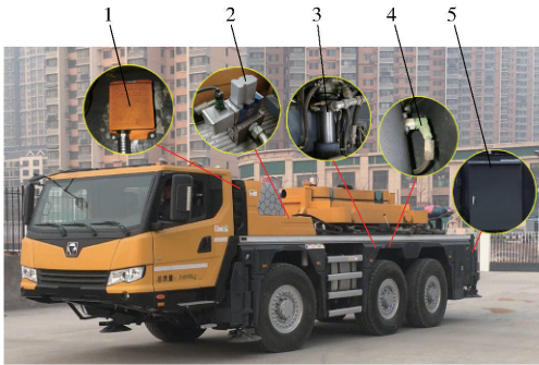
图 10 试验样机 Fig. 10 Experiment prototype 1. IMU 2. 三位四通电液伺服阀 3. 悬挂作动油缸 4. 位移传感器 5. 电控柜
