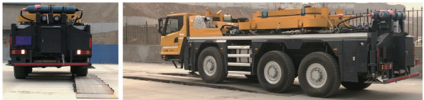
(a) 过单边桥 (b) 过双边桥 图 14 行车调平试验现场
