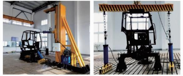
(a) 水平侧向加载试验
