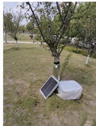
图 10 海棠树液流监测试验
