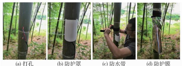
图 7 探针安装示意图
