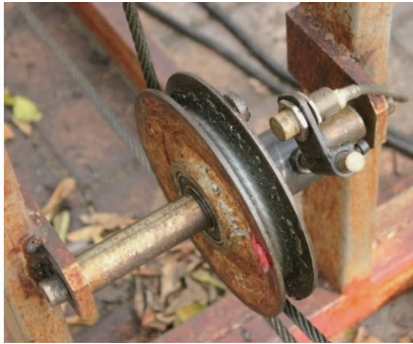
图 10 试验台接近开关安装现场图
