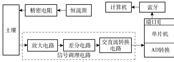
图 3 系统设计示意图
