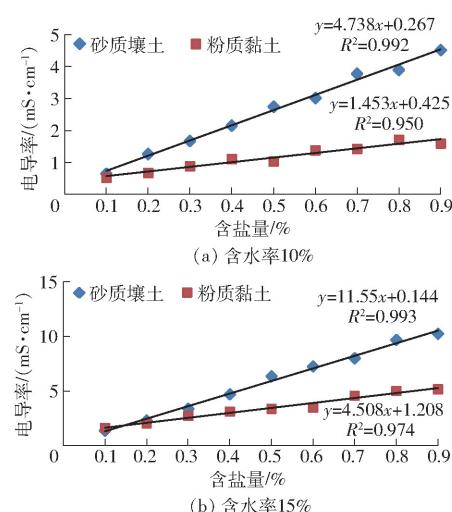
图9 TDR测量仪在砂质壤土和粉质黏土中的测量结果
