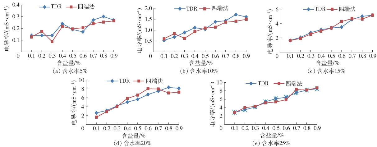
图7 四端法和TDR测量仪在粉质黏土中的测量结果
