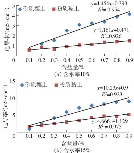
图8 四端法电导率测量仪在砂质壤土和粉质黏土中的测量结果
