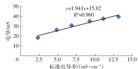
图 4 基于四端法的电导率测量仪的标定
