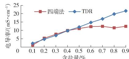
图 5 TDR 和四端法电导率测量仪测得的电导率对比
