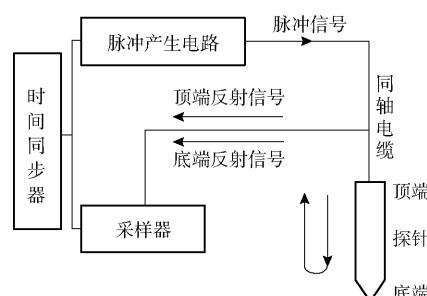
图 2 TDR 测量原理示意图
