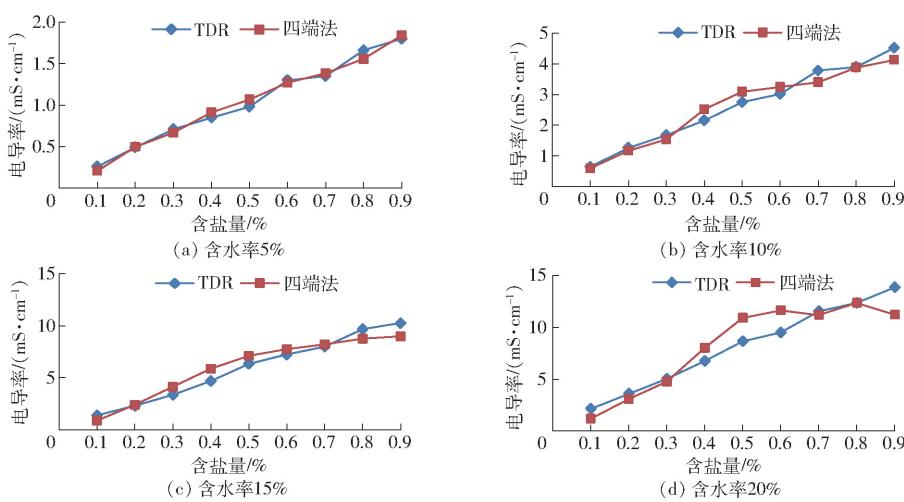
图6 四端法和TDR测量仪在砂质壤土中的测量结果
