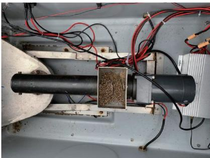
图 4 螺旋输送装置
